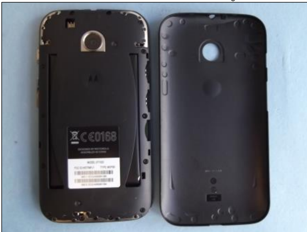
Photo 5: EST – vue arrière ouvert – batterie intégrée
