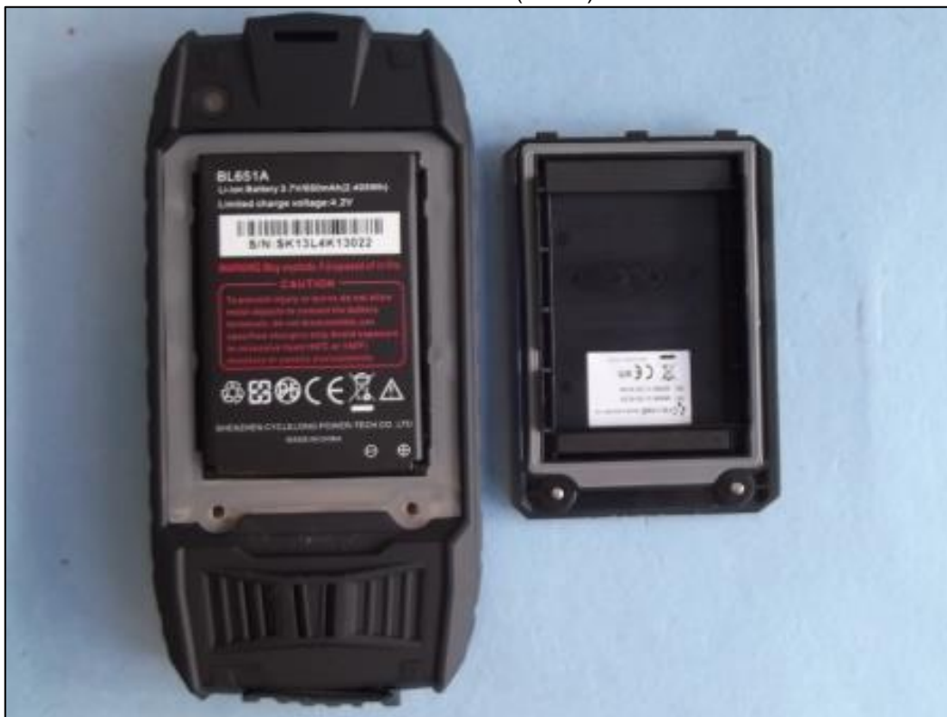
Photo 5: EST – vue arrière (ouvert) avec batterie
