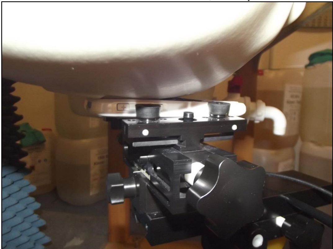
Photo 14: Position d'essai main droite, contre la joue
