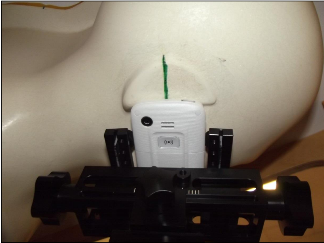
Photo 16: Position d'essai main droite, incliné 15°
