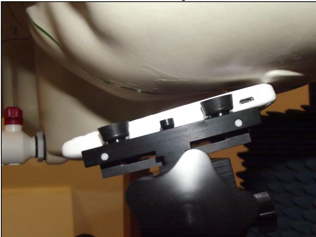
Photo 12: Position d'essai main gauche, incliné 15°
