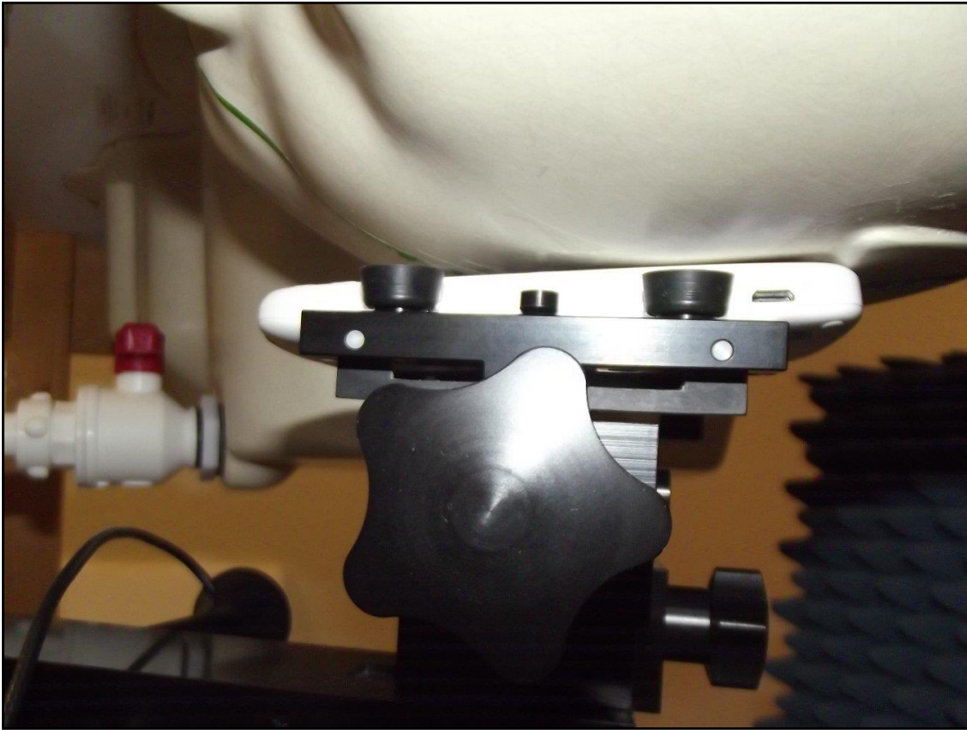
Photo 10: Position d'essai main gauche, contre la joue
