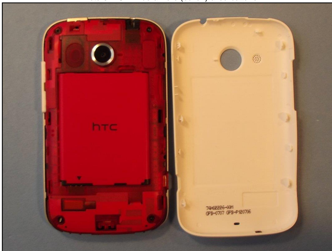
Photo 5: EST – vue arrière (ouvert) avec batterie
