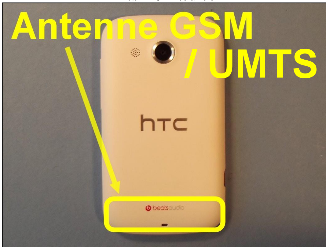
Photo 4: EST – vue arrière
