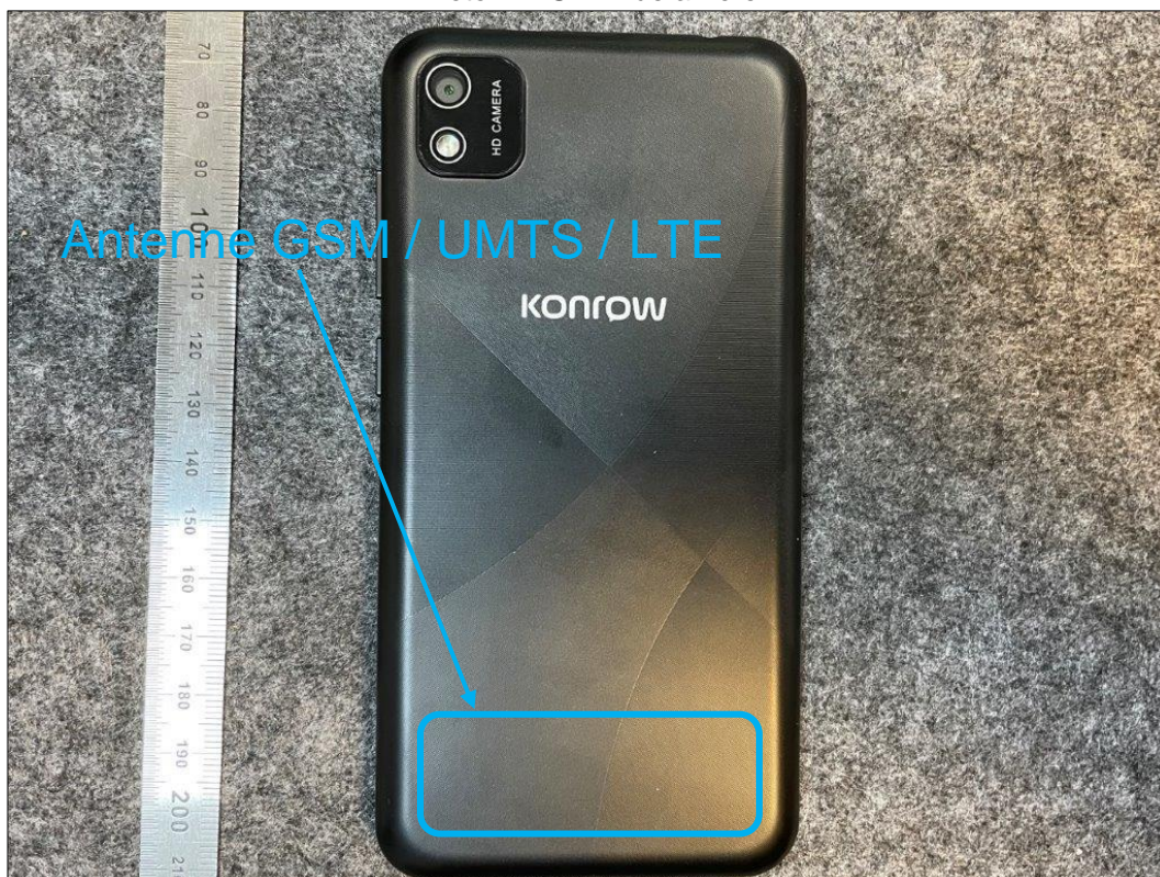
Photo 4: EST – vue arrière
