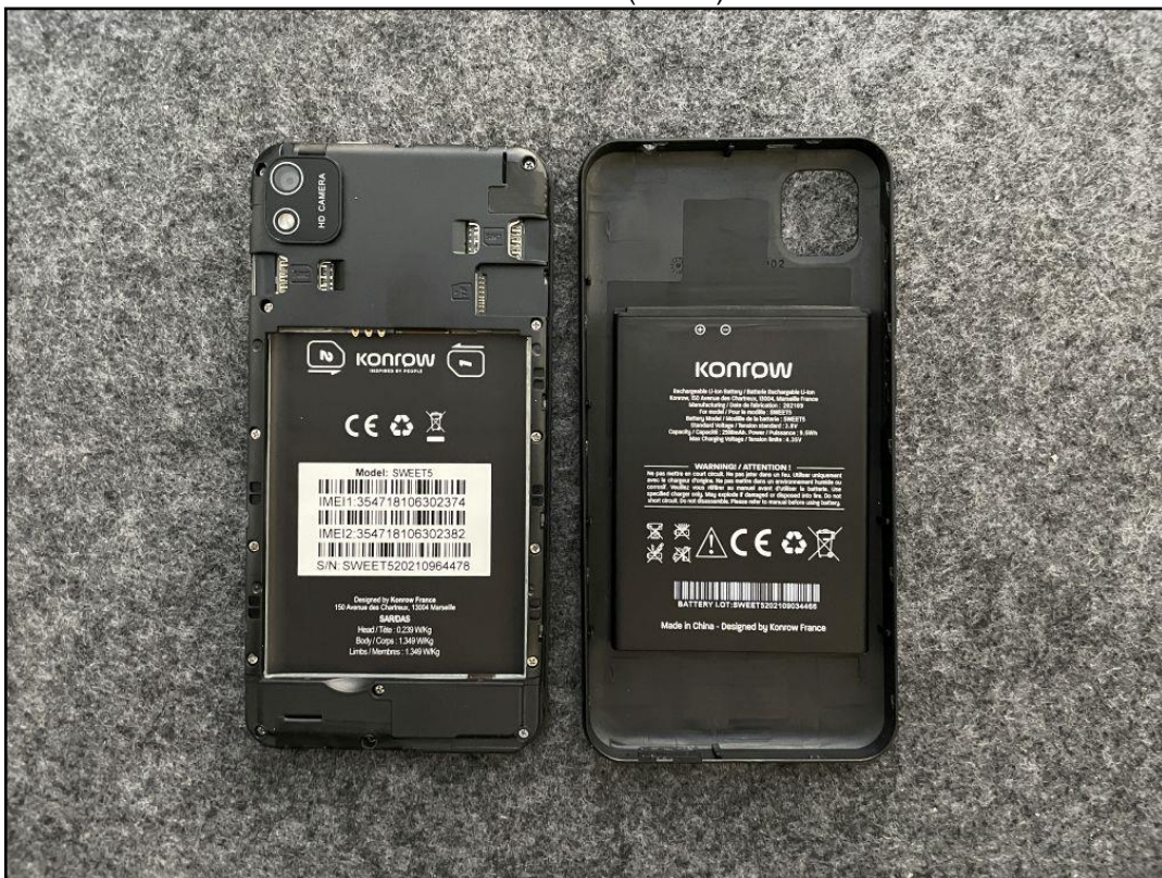
Photo 6: EST – vue arrière (ouvert) sans batterie
