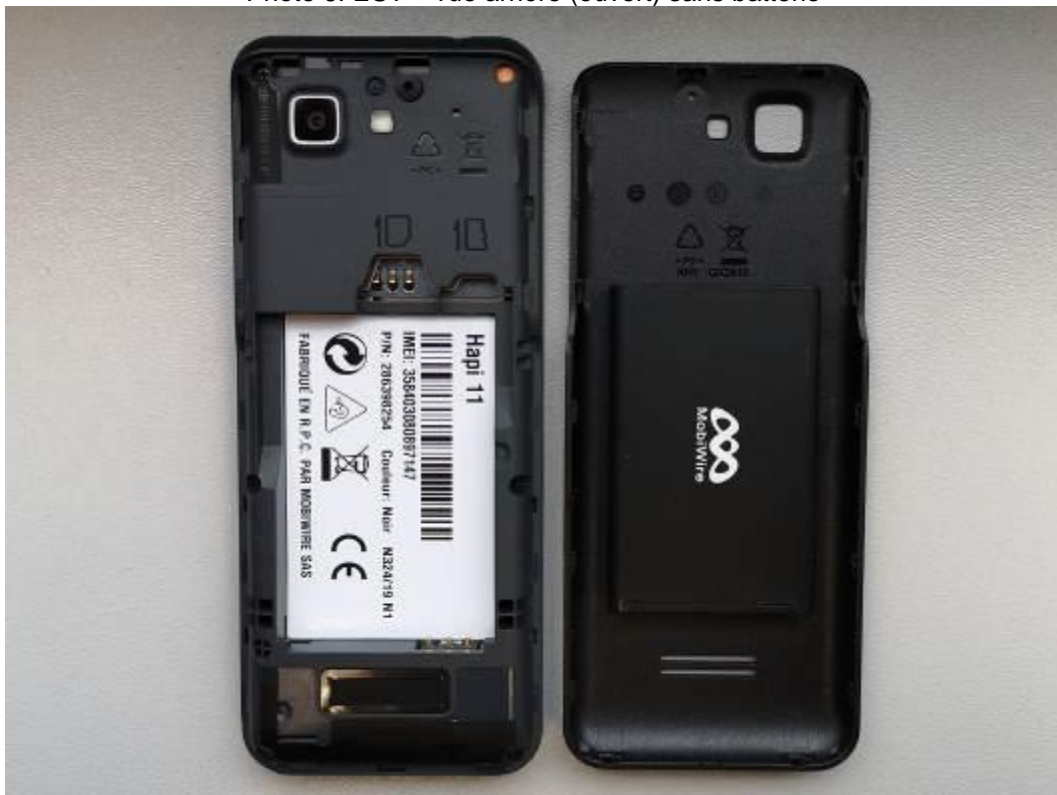
Photo 6: EST – vue arrière (ouvert) sans batterie
