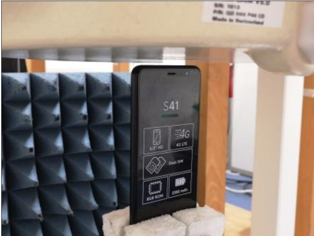
Photo 13: Position d'essai face du dessus contre le corps (distance 5 mm)
