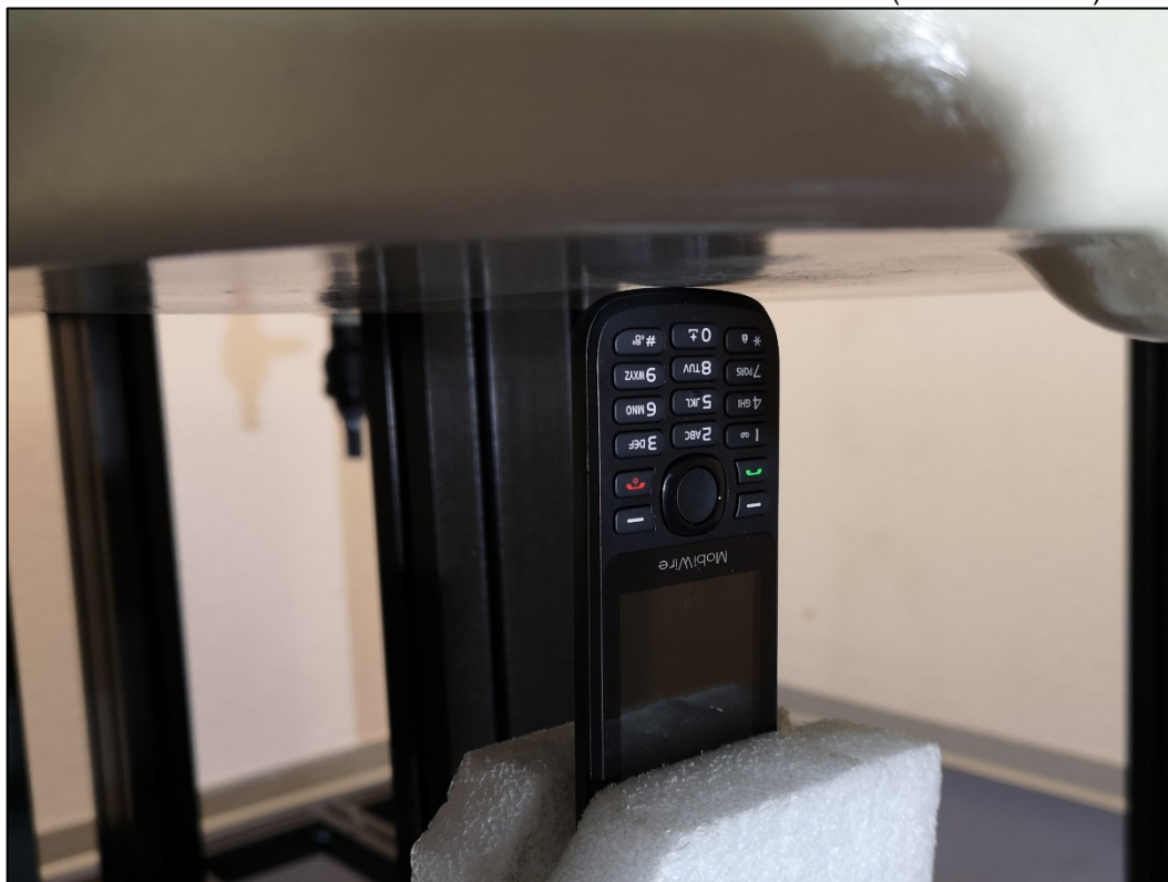
Photo 13: Position d'essai face du dessous contre le membre (distance 0 mm)
