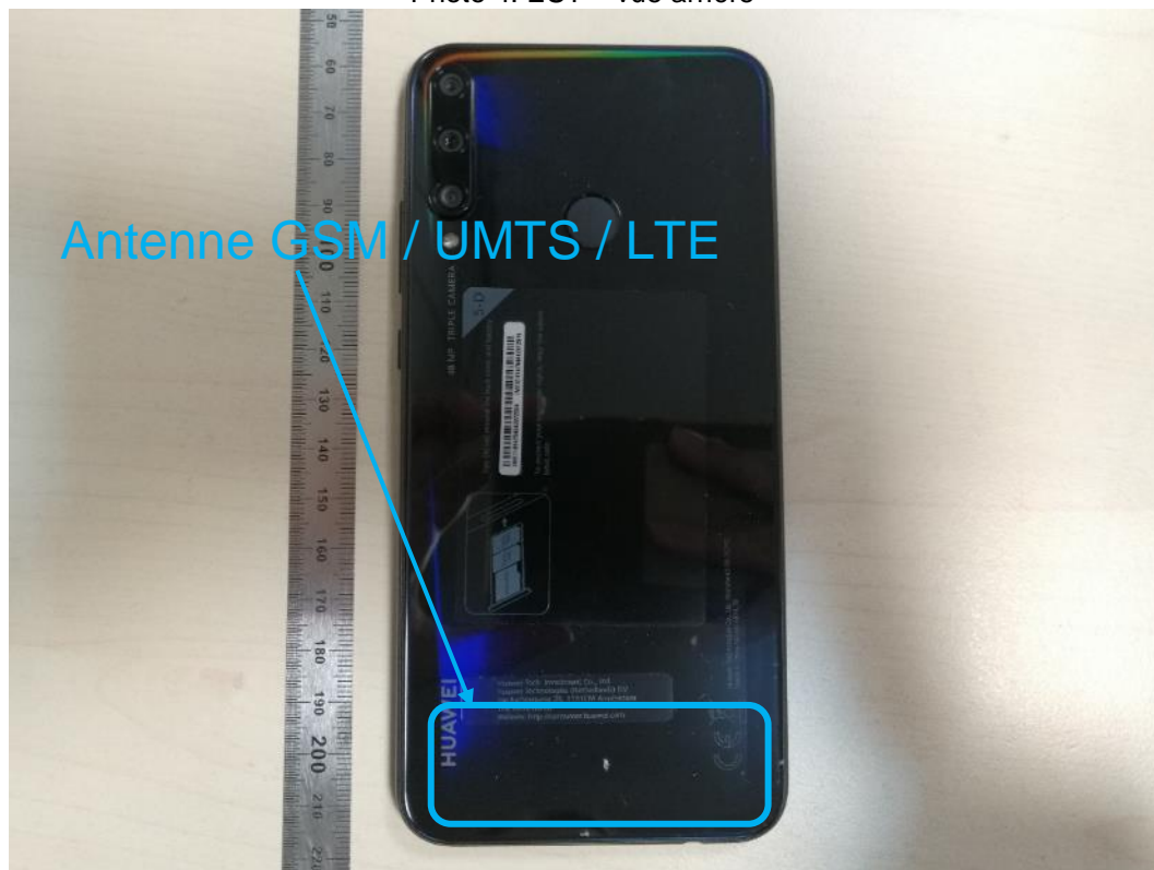
Photo 4: EST – vue arrière
