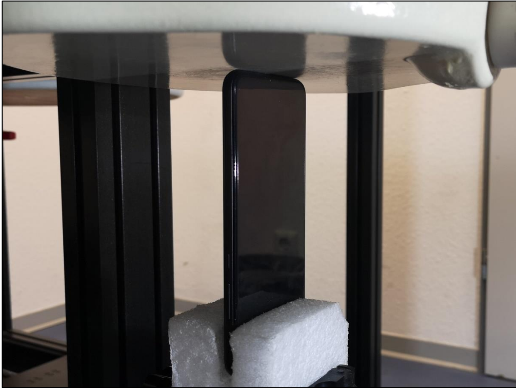
Photo 11: Position d'essai face du dessous contre le corps (distance 5 mm)
