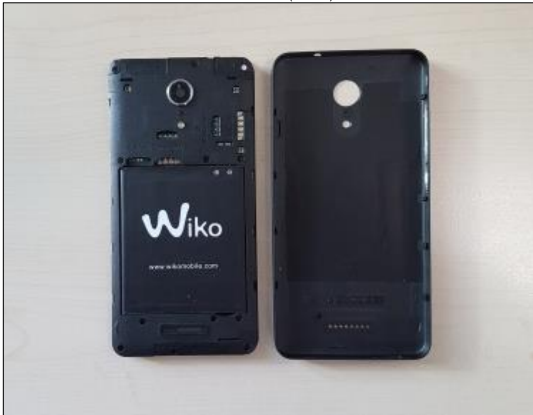
Photo 6: EST – vue arrière (ouvert) sans batterie
