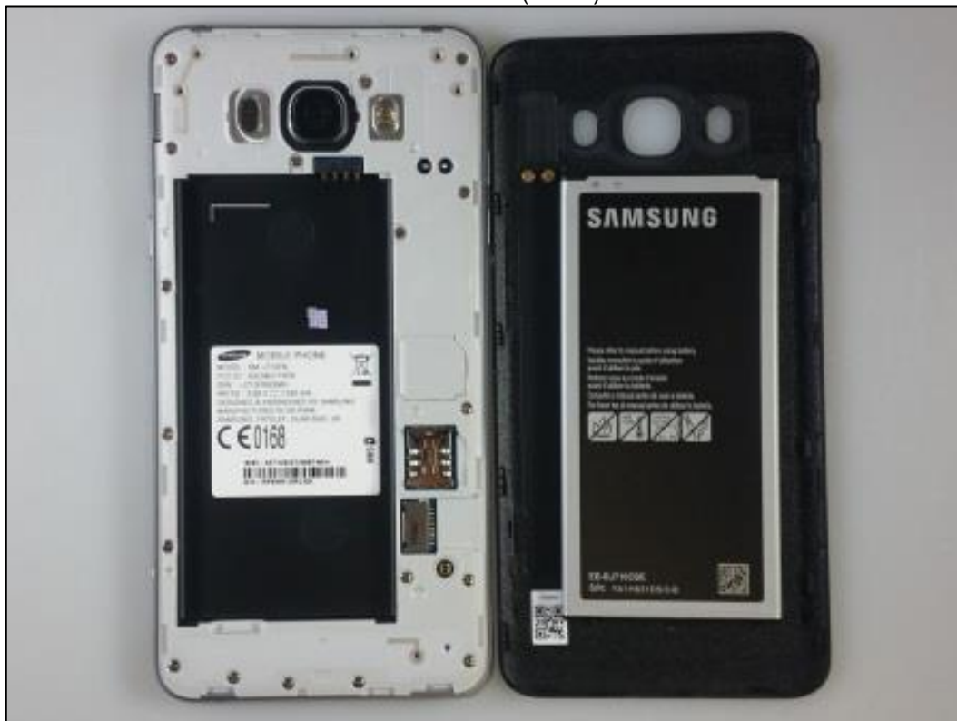
Photo 6: EST – vue arrière (ouvert) sans batterie
