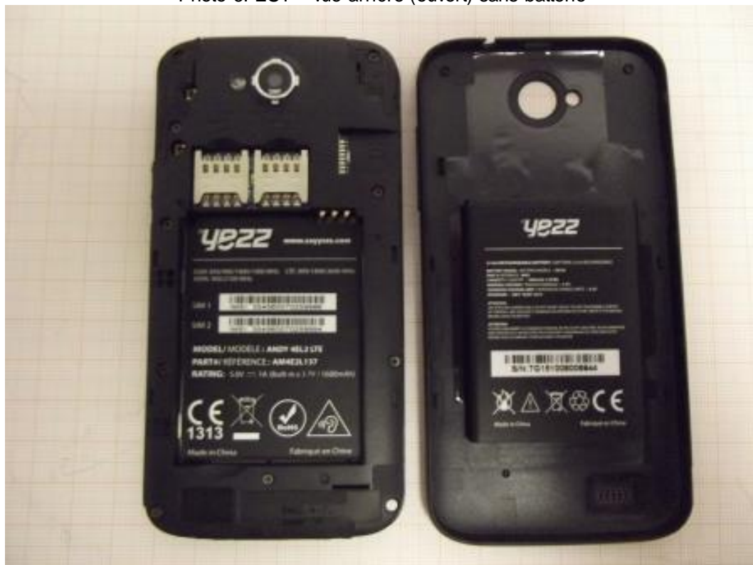
Photo 6: EST – vue arrière (ouvert) sans batterie
