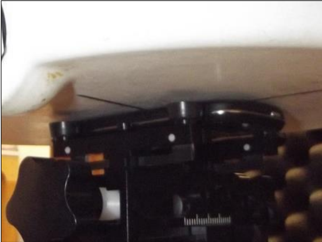
Photo 10: Position d'essai face avant contre le corps (distance 5 mm)
