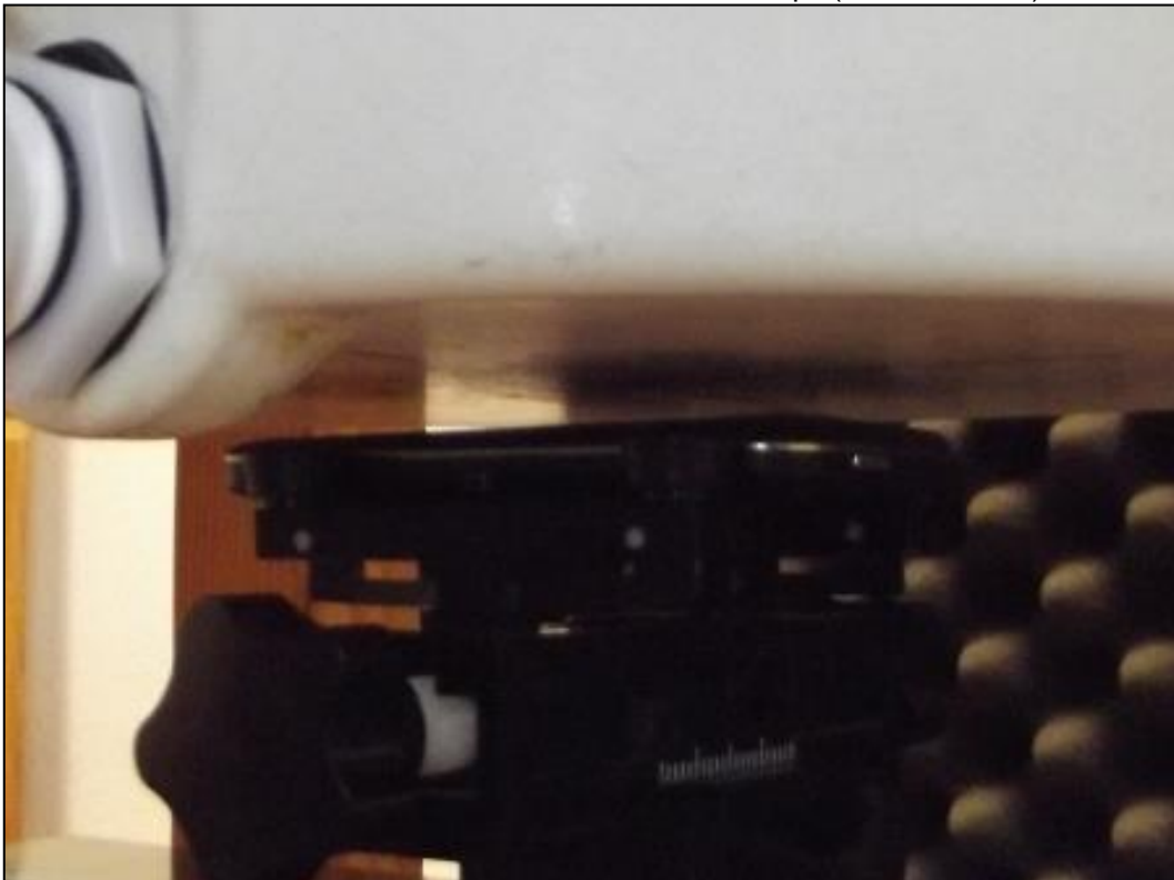
Photo 10: Position d'essai face avant contre le corps (distance 5 mm)
