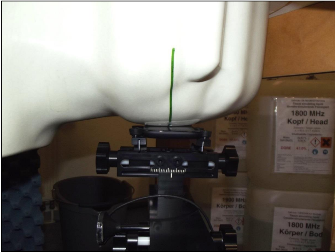
Photo 8: Position d'essai main gauche, contre la joue
