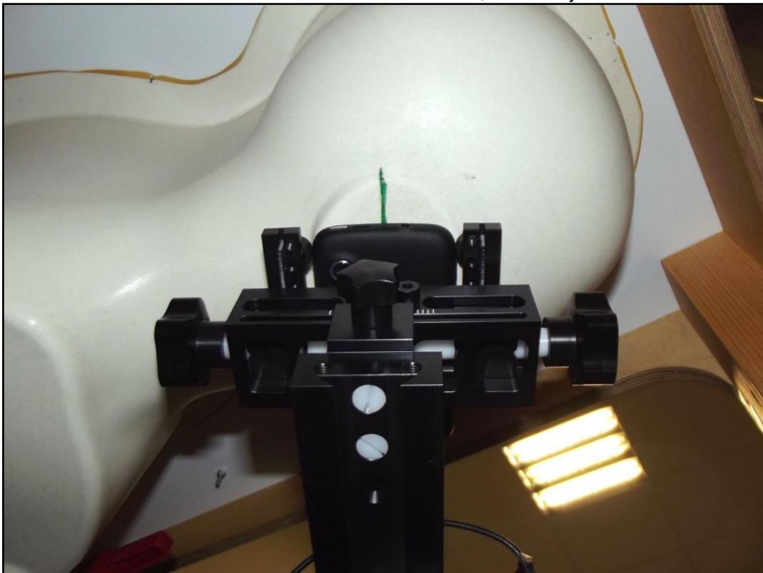
Photo 14: Position d'essai main droite, contre la joue
