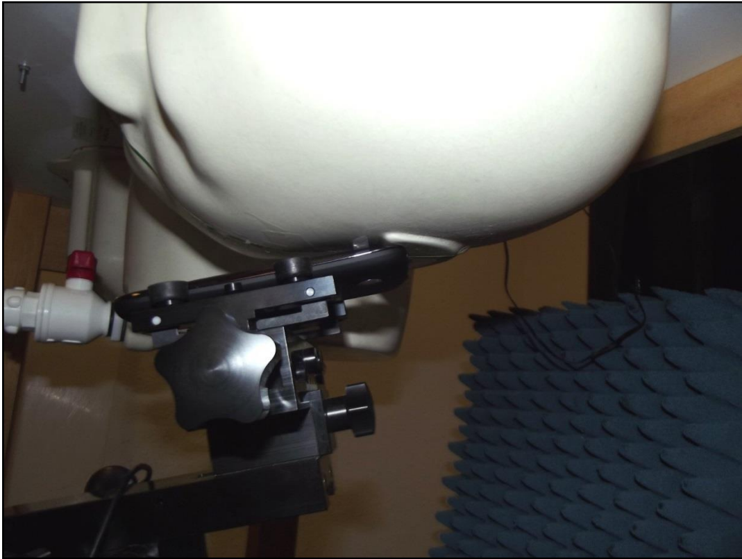
Photo 12: Position d'essai main droite, contre la joue
