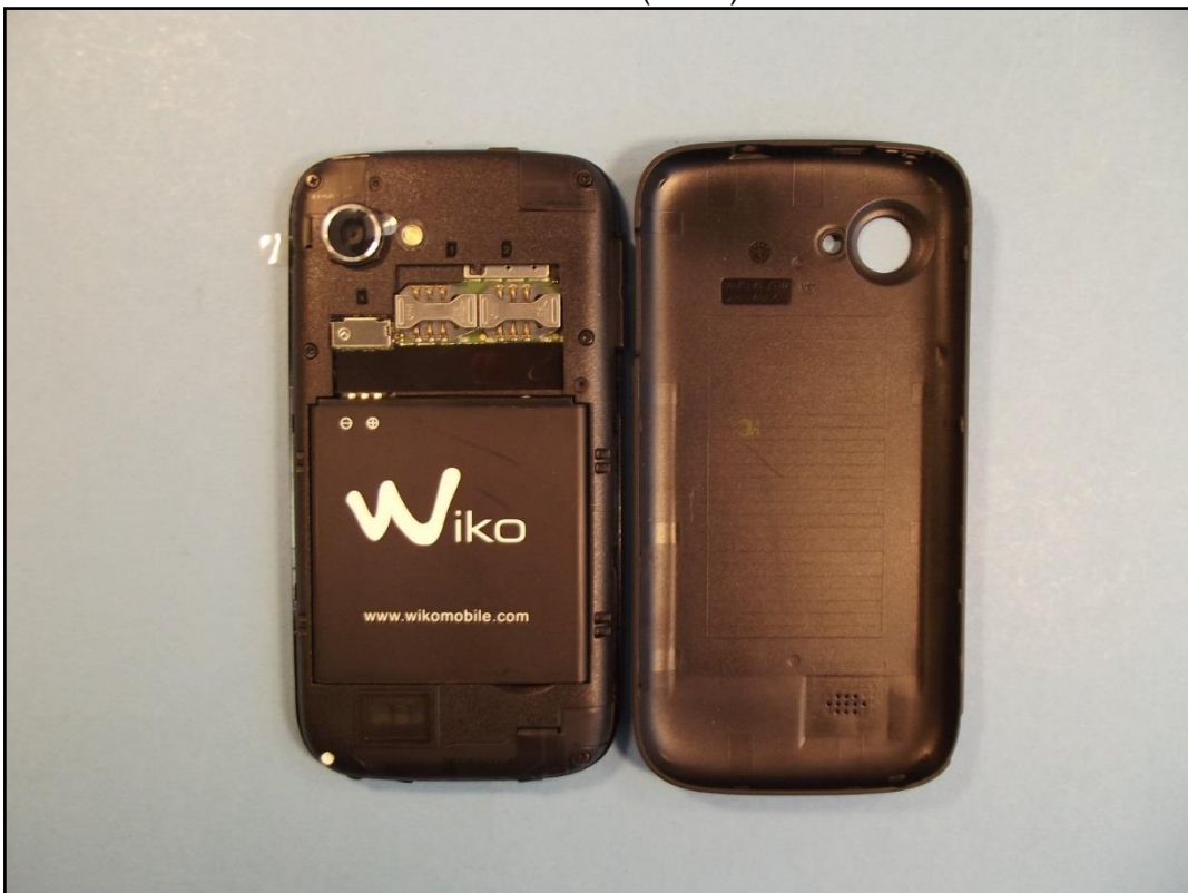
Photo 4: EST – vue arrière (ouvert) avec batterie
