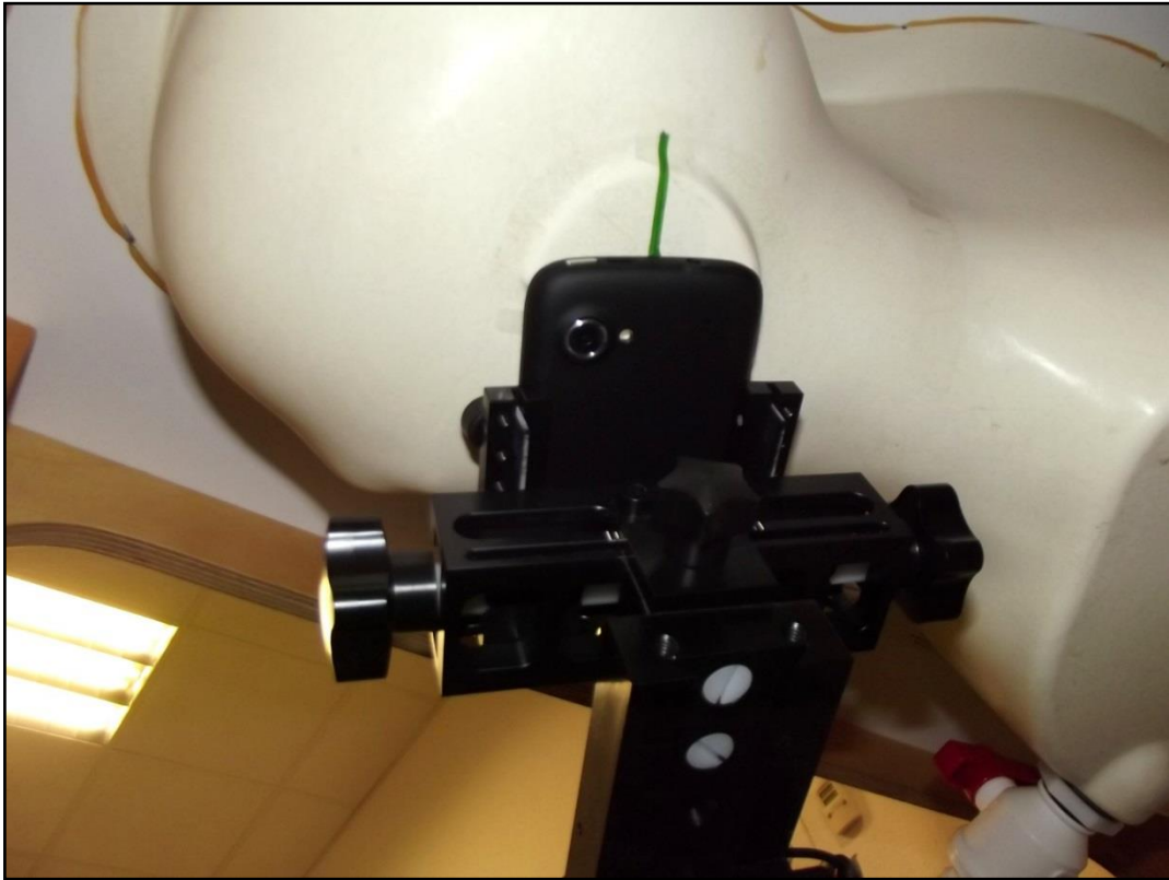
Photo 10: Position d'essai main gauche, incliné 15°
