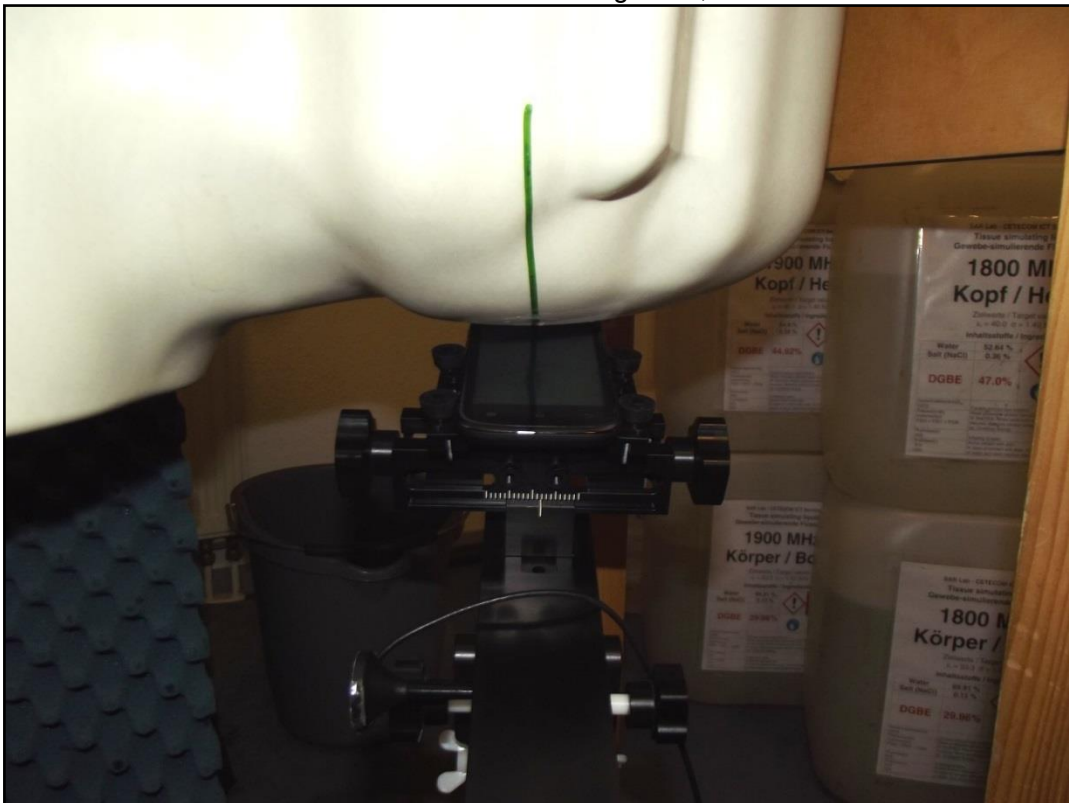
Photo 10: Position d'essai main gauche, incliné 15°
