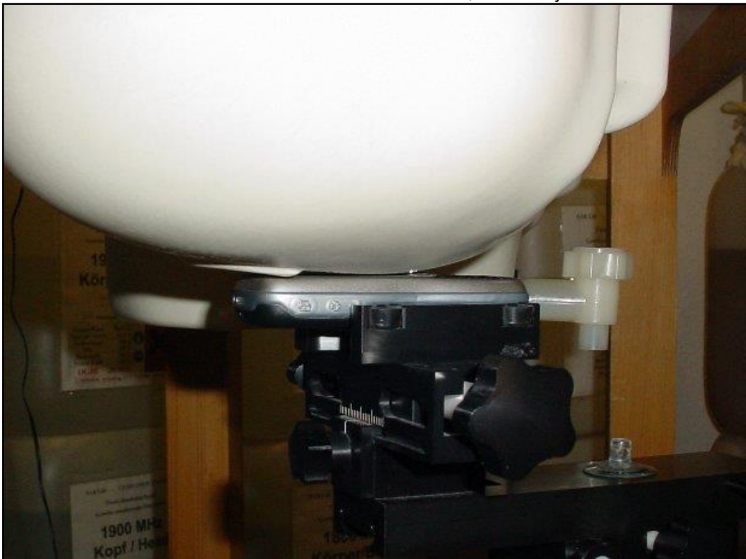
Photo 14: Position d'essai main droite, contre la joue
