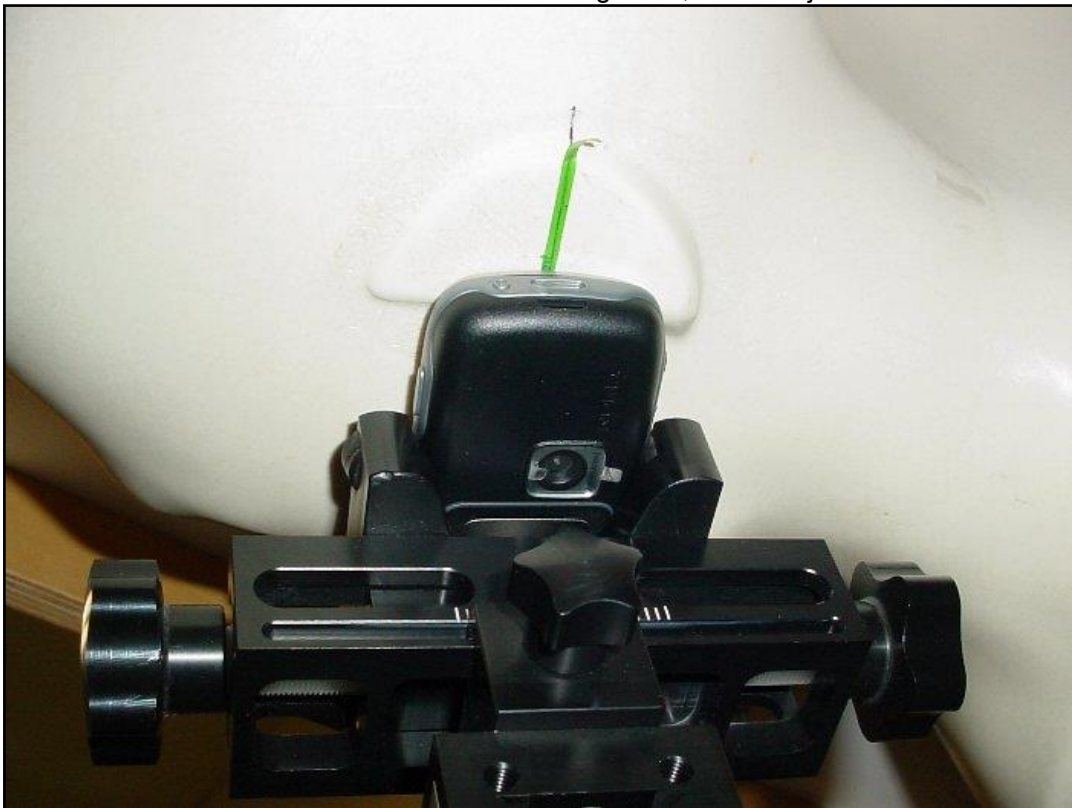
Photo 10: Position d'essai main gauche, contre la joue
