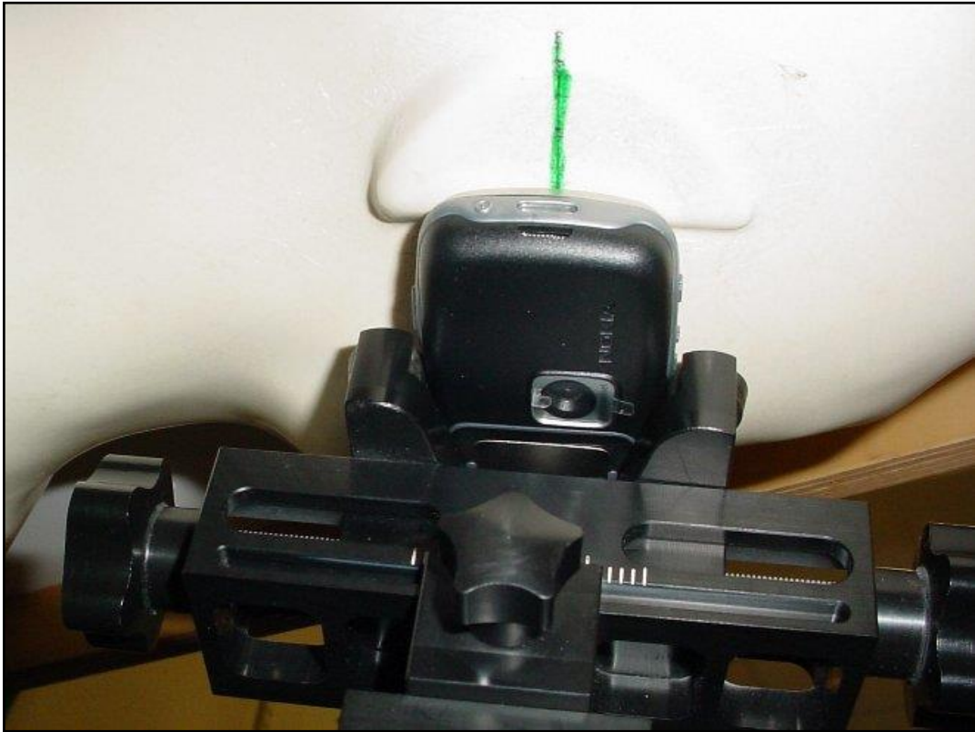
Photo 16: Position d'essai main droite, incliné 15°
