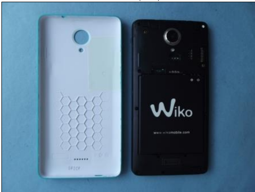
Photo 5: EST – vue arrière (ouvert) avec batterie
