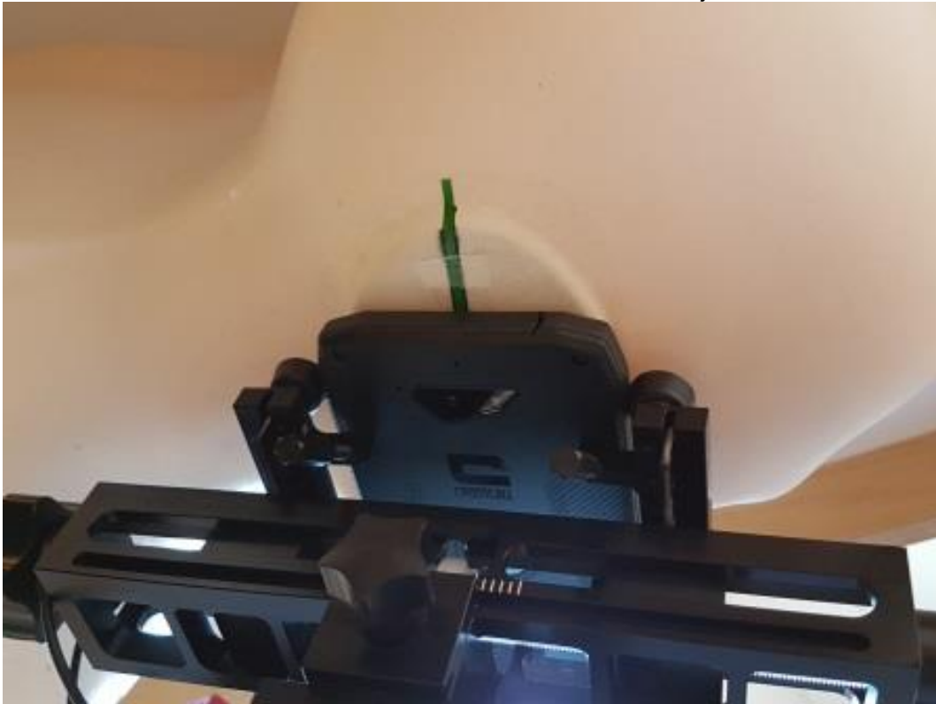
Photo 14: Position d'essai main droite, incliné 15°
