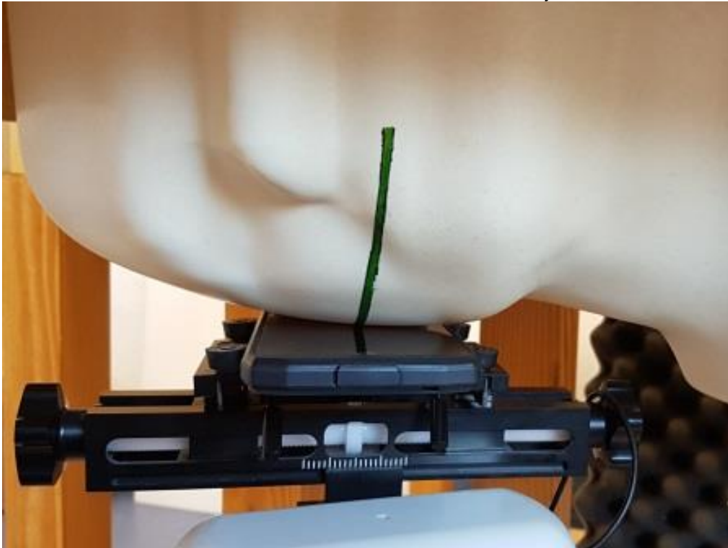
Photo 12: Position d'essai main droite, contre la joue
