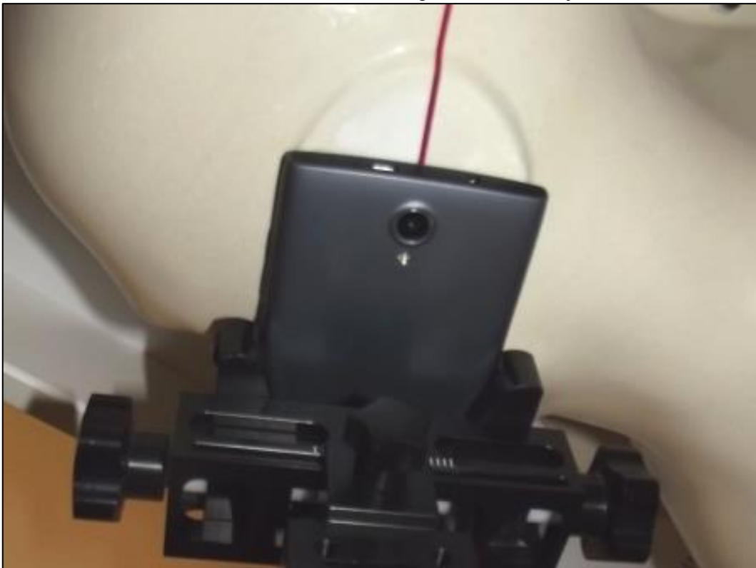
Photo 10: Position d'essai main gauche, incliné 15°
