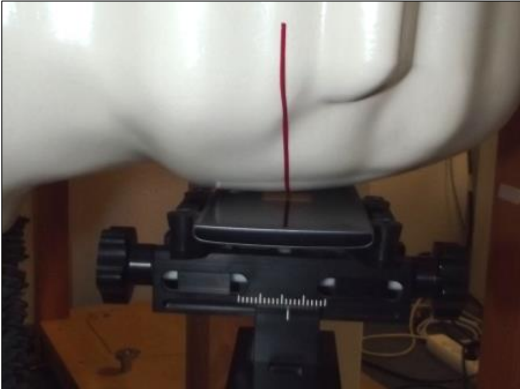
Photo 7: Position d'essai main gauche, contre la joue
