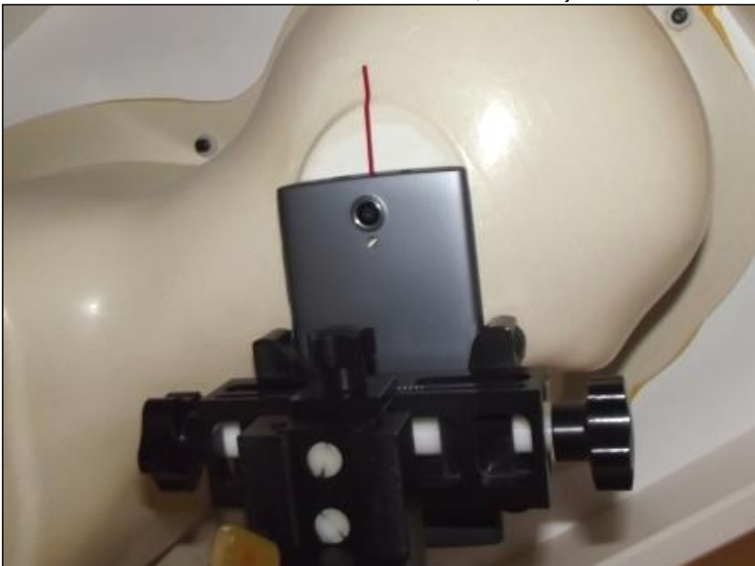
Photo 14: Position d'essai main droite, contre la joue
