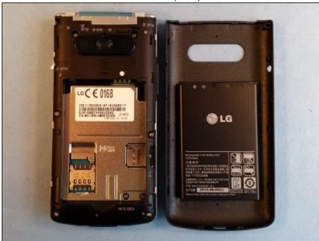
Photo 7: EST – vue arrière (ouvert) sans batterie
