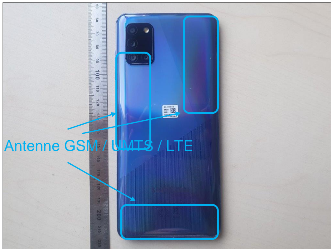
Photo 4: EST – vue arrière
