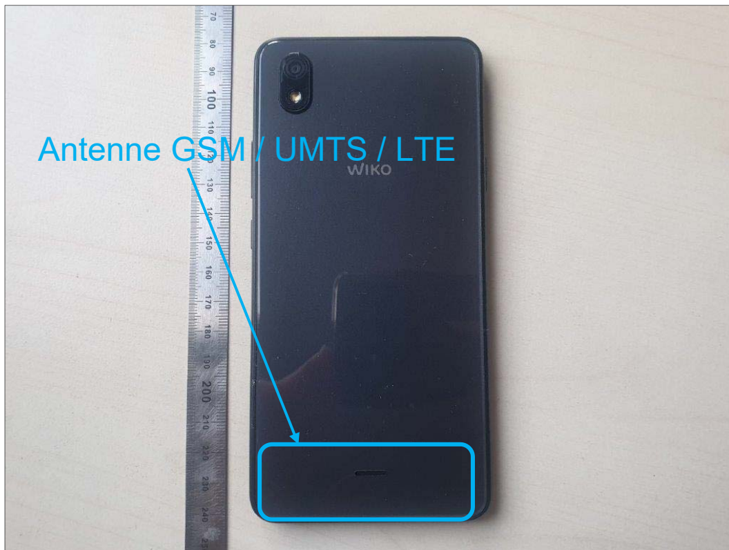
Photo 4: EST – vue arrière
