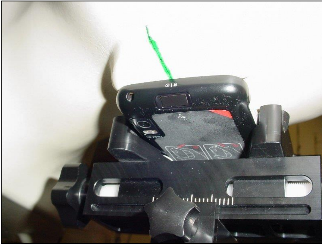
Photo 16: Position d'essai main droite, incliné 15°
