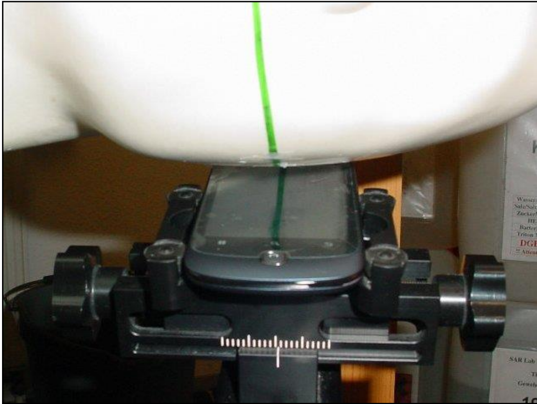
Photo 12: Position d'essai main gauche, incliné 15°
