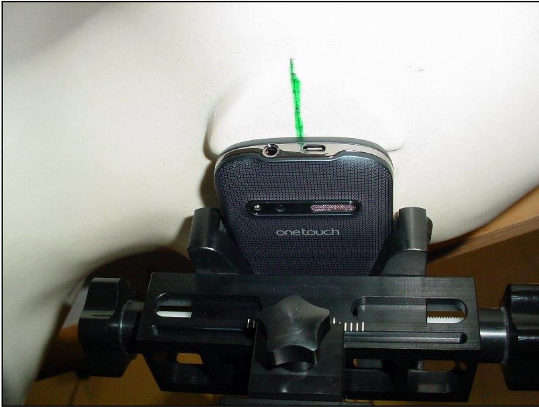
Photo 16: Position d'essai main droite, incliné 15°
