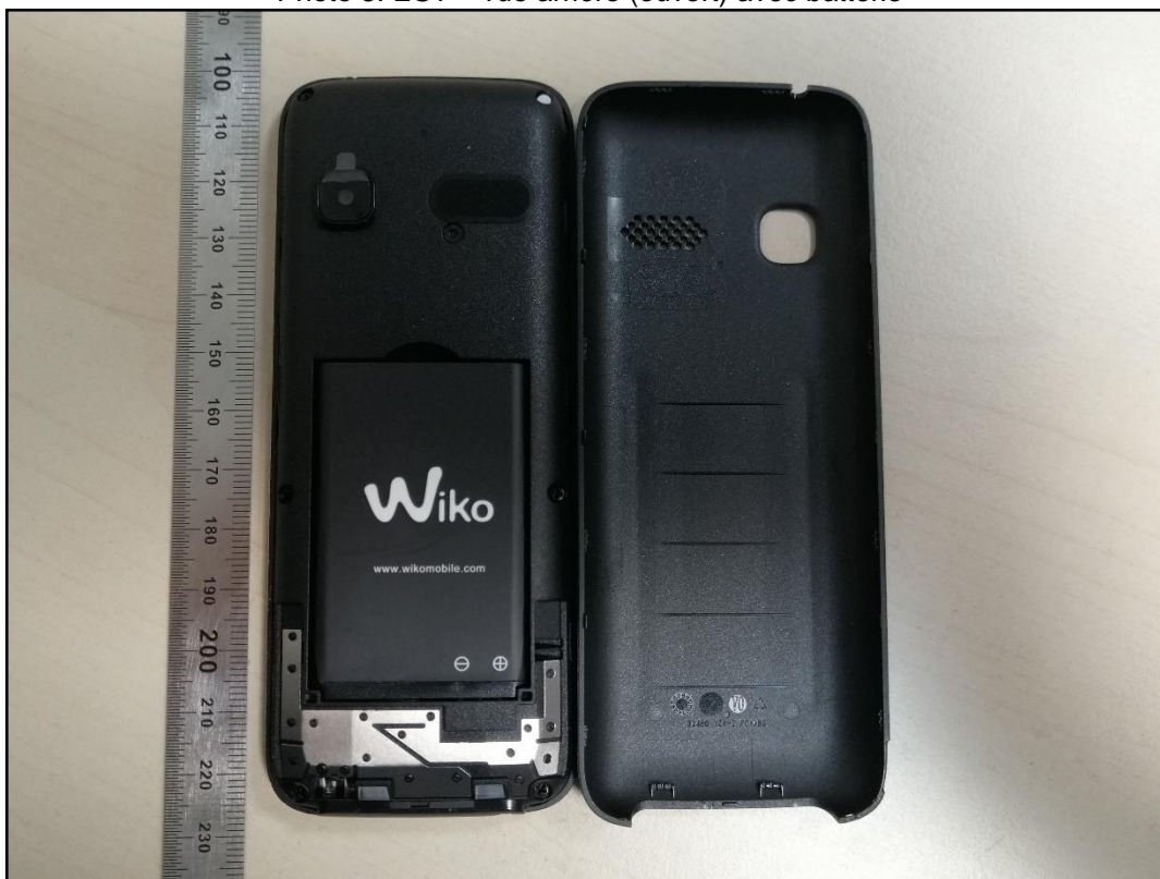
Photo 5: EST – vue arrière (ouvert) avec batterie
