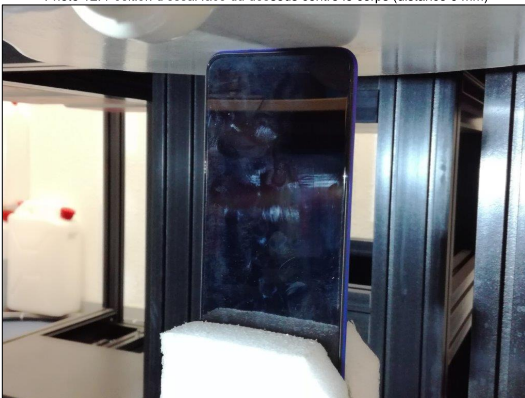
Photo 12: Position d'essai face du dessous contre le corps (distance 0 mm)
