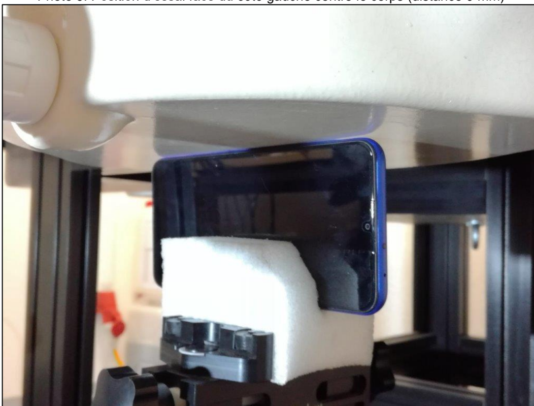
Photo 10: Position d'essai face du côté droite contre le corps (distance 0 mm)
