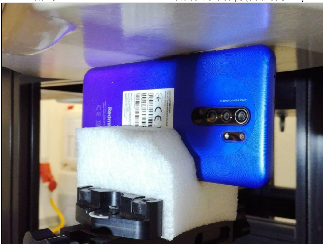
Photo 10: Position d'essai face du côté droite contre le corps (distance 0 mm)
