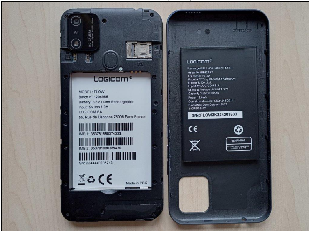
Photo 6: EST – vue arrière (ouvert) sans batterie
