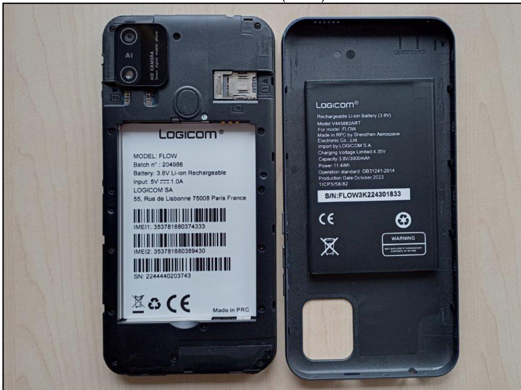
Photo 6: EST – vue arrière (ouvert) sans batterie
