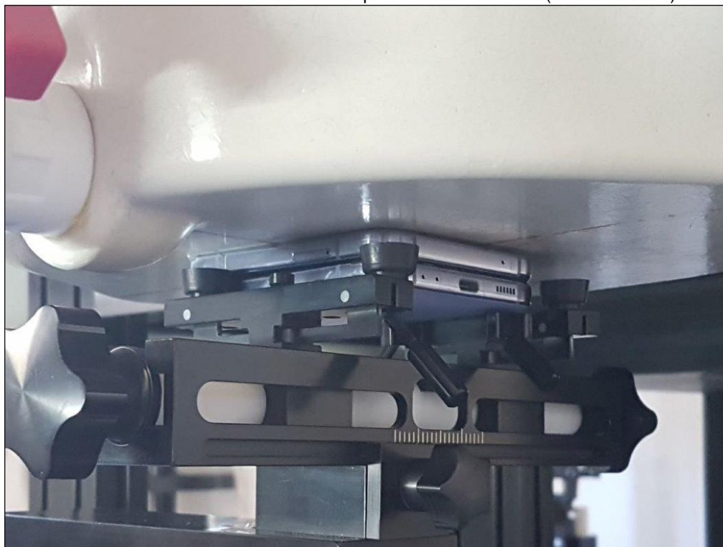
Photo 14: : Position d'essai face arrière plié contre le membre (distance 0 mm)
