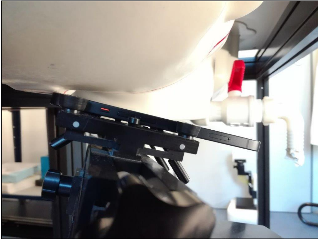
Photo 15: Position d'essai main droite, incliné 15°
