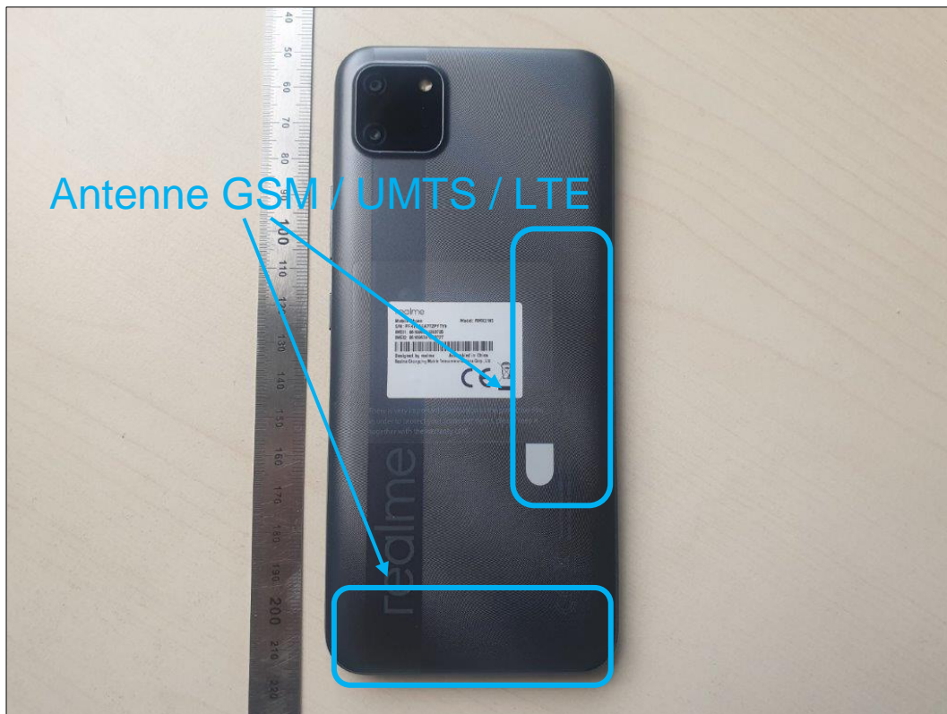
Photo 4: EST – vue arrière
