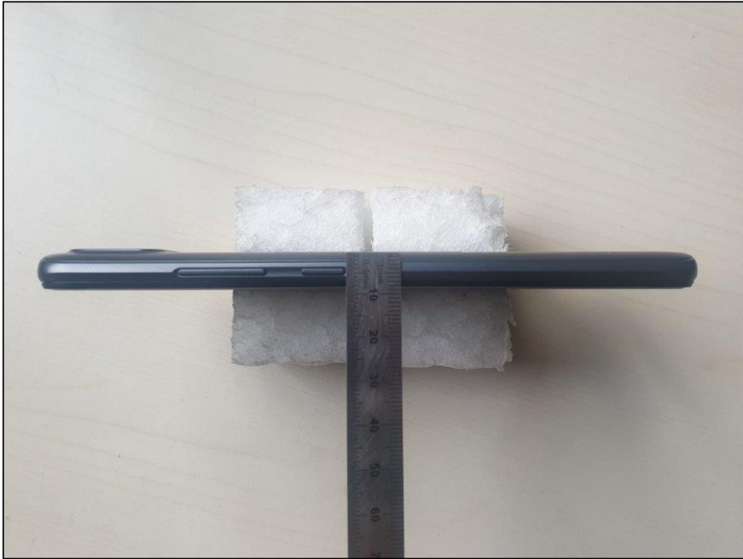
Photo 3: EST – vue de côté
