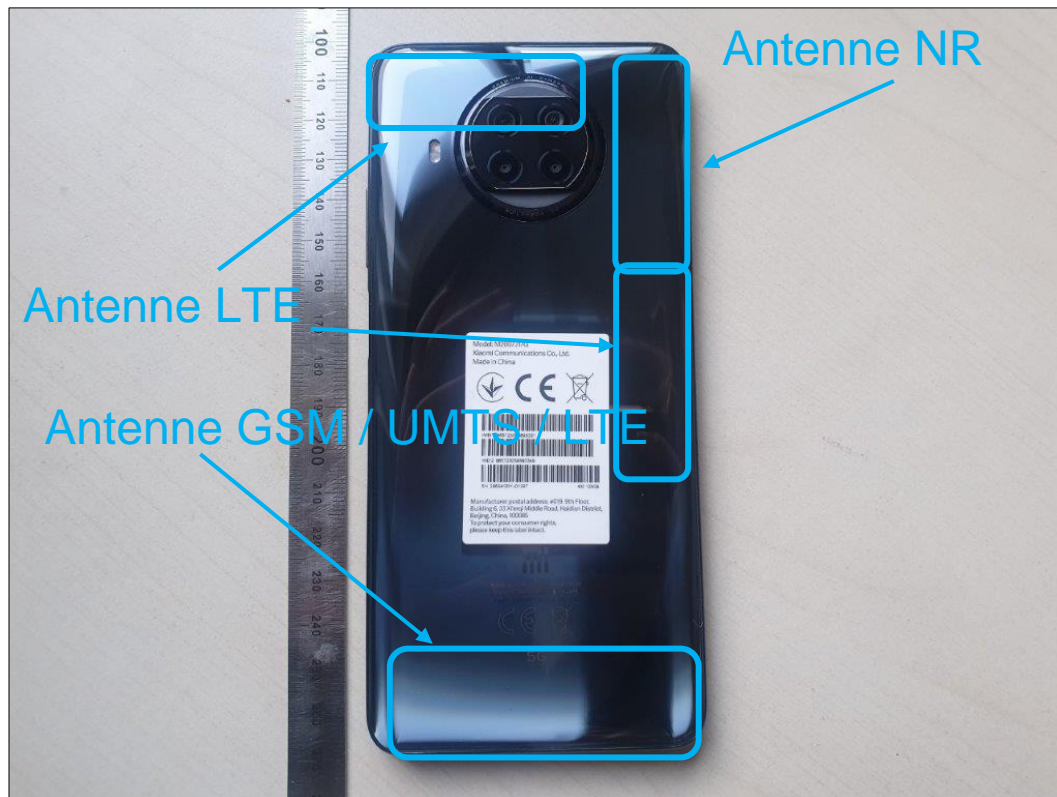
Photo 4: EST – vue arrière
