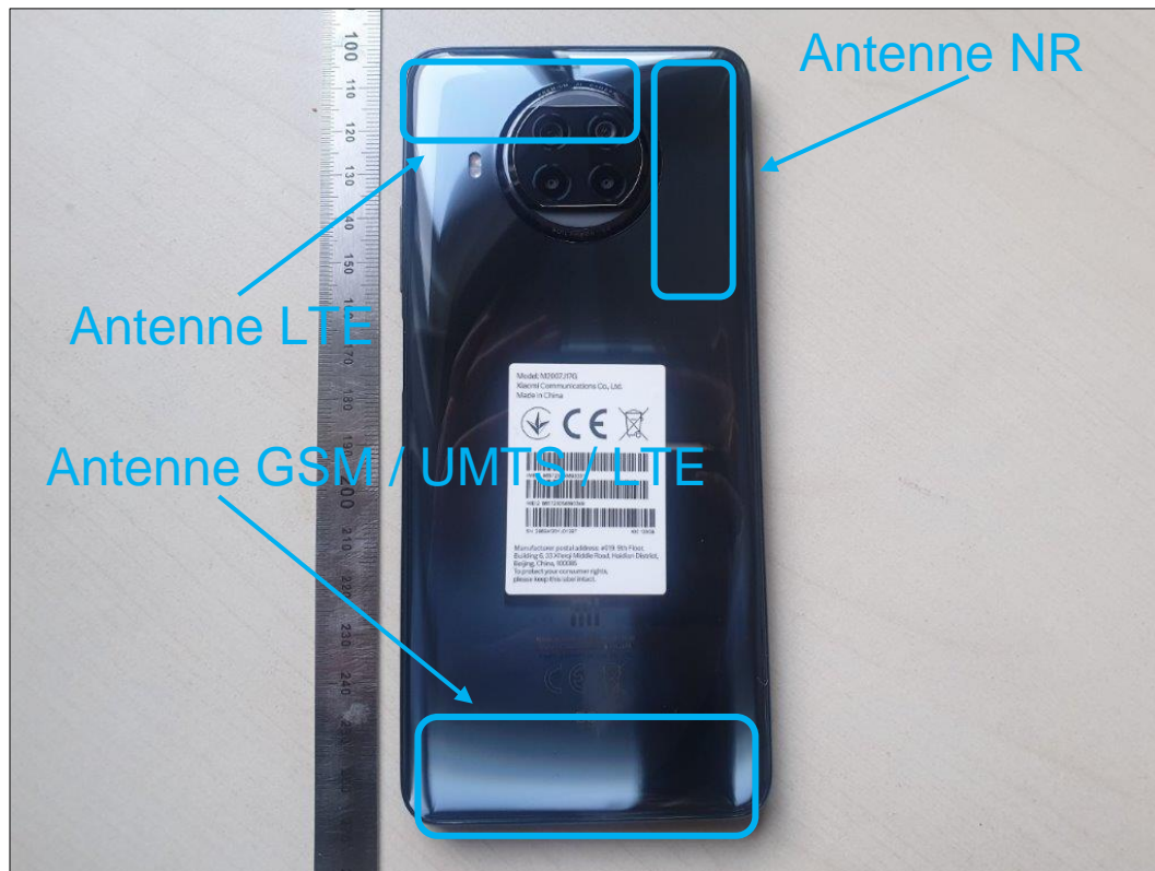
Photo 4: EST – vue arrière
