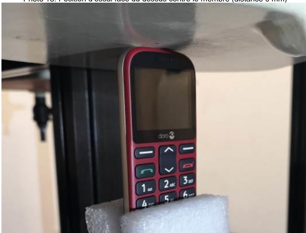
Photo 14: Position d'essai face du dessous contre le membre (distance 0 mm)
