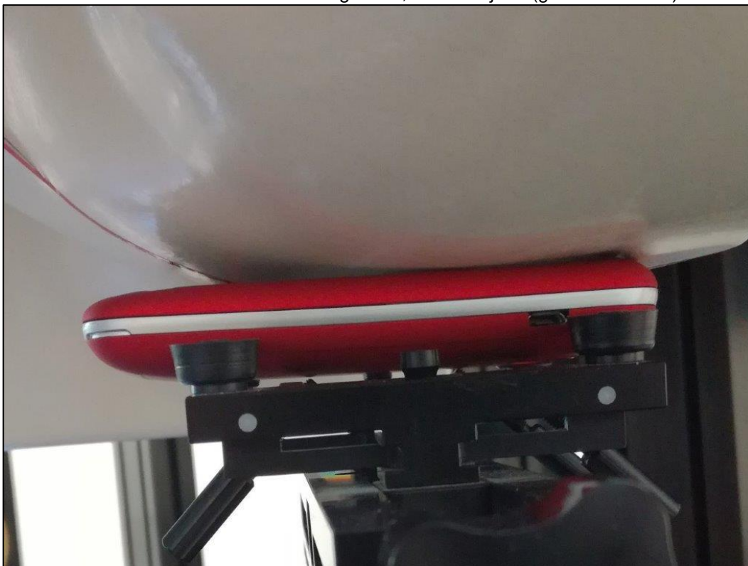
Photo 9: Position d'essai main gauche, contre la joue (glissière fermée)
