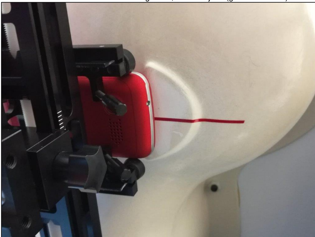
Photo 10: Position d'essai main gauche, contre la joue (glissière fermée)
