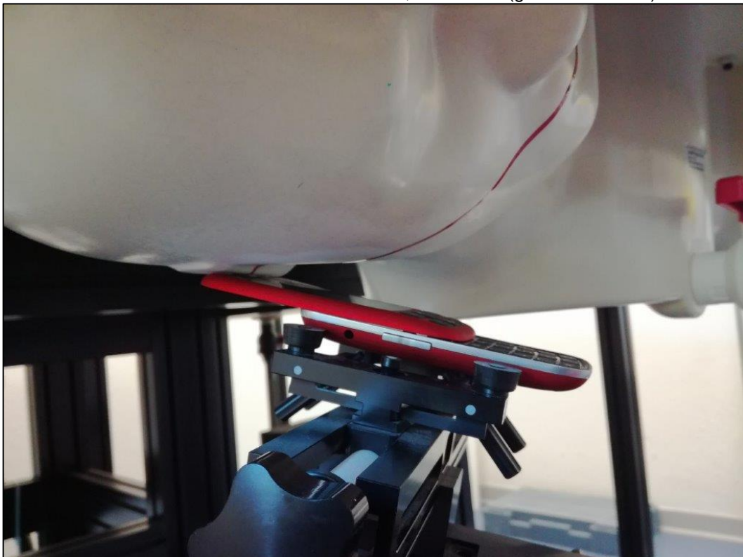
Photo 26: Position d'essai main droite, incliné 15° (glissière ouverte)
