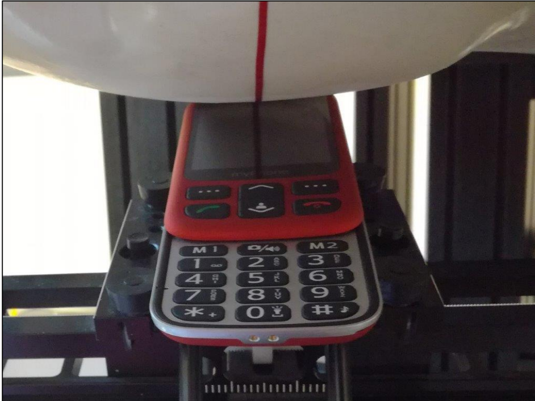
Photo 25: Position d'essai main droite, incliné 15° (glissière ouverte)
