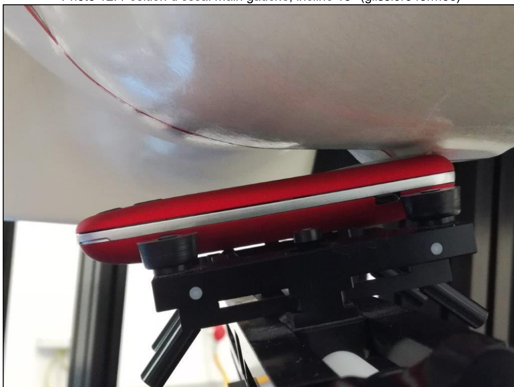
Photo 12: Position d'essai main gauche, incliné 15° (glissière fermée)
