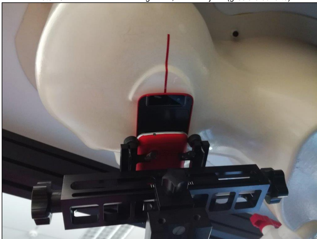
Photo 19: Position d'essai main gauche, contre la joue (glissière ouverte)
