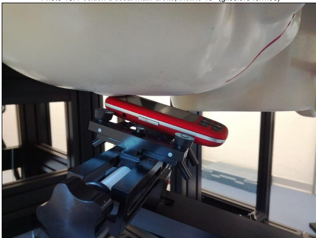
Photo 16: Position d'essai main droite, incliné 15° (glissière fermée)
