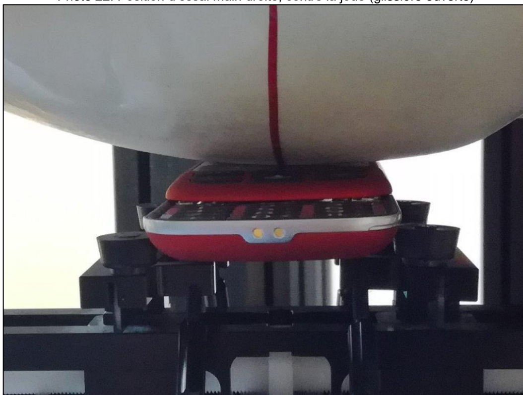
Photo 22: Position d'essai main droite, contre la joue (glissière ouverte)
