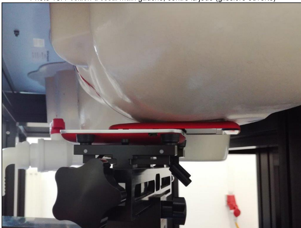
Photo 18: Position d'essai main gauche, contre la joue (glissière ouverte)
