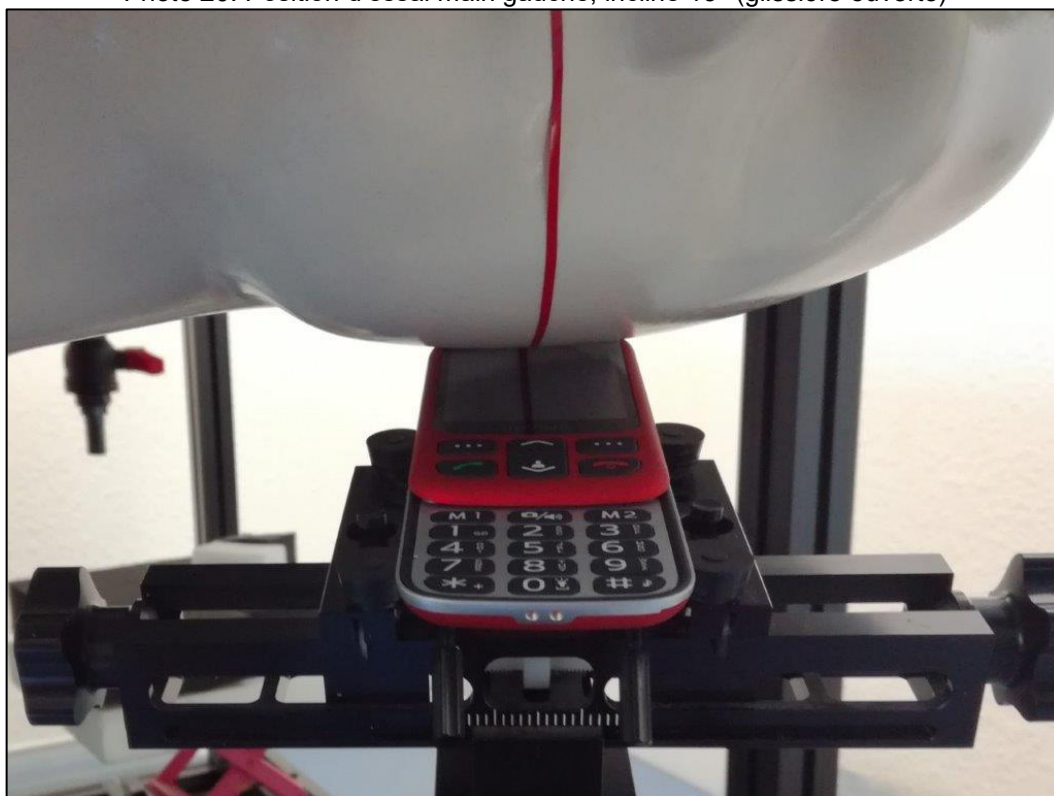
Photo 20: Position d'essai main gauche, incliné 15° (glissière ouverte)
