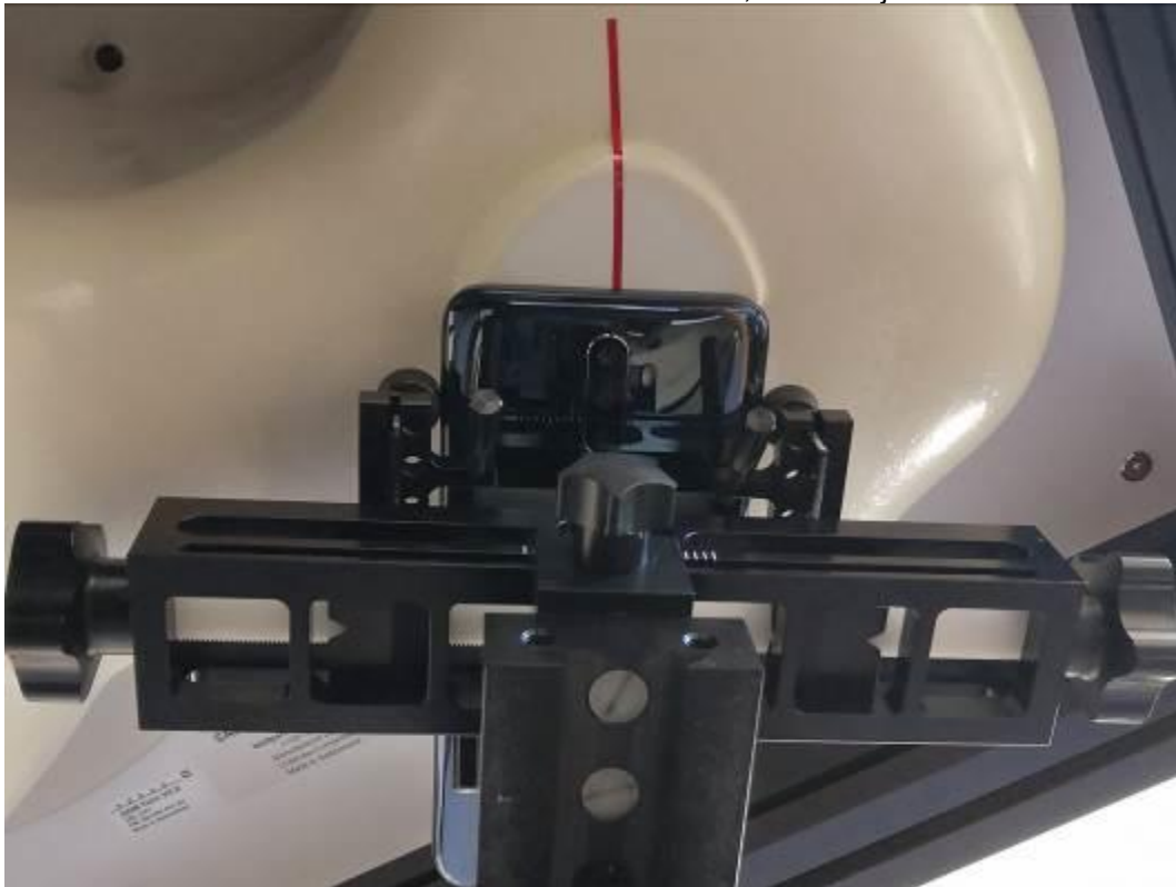
Photo 14: Position d'essai main droite, incliné 15°
