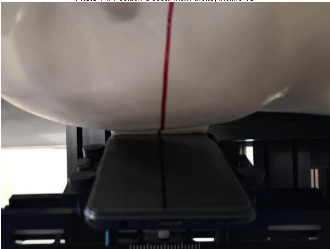
Photo 14: Position d'essai main droite, incliné 15°
