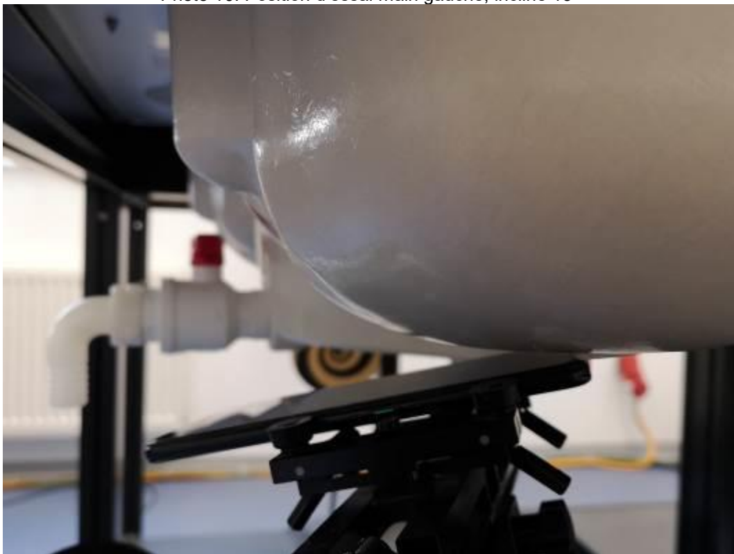
Photo 10: Position d'essai main gauche, incliné 15°
