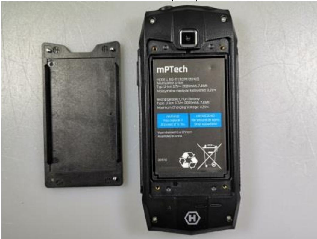
Photo 6: EST – vue arrière (ouvert) sans batterie
