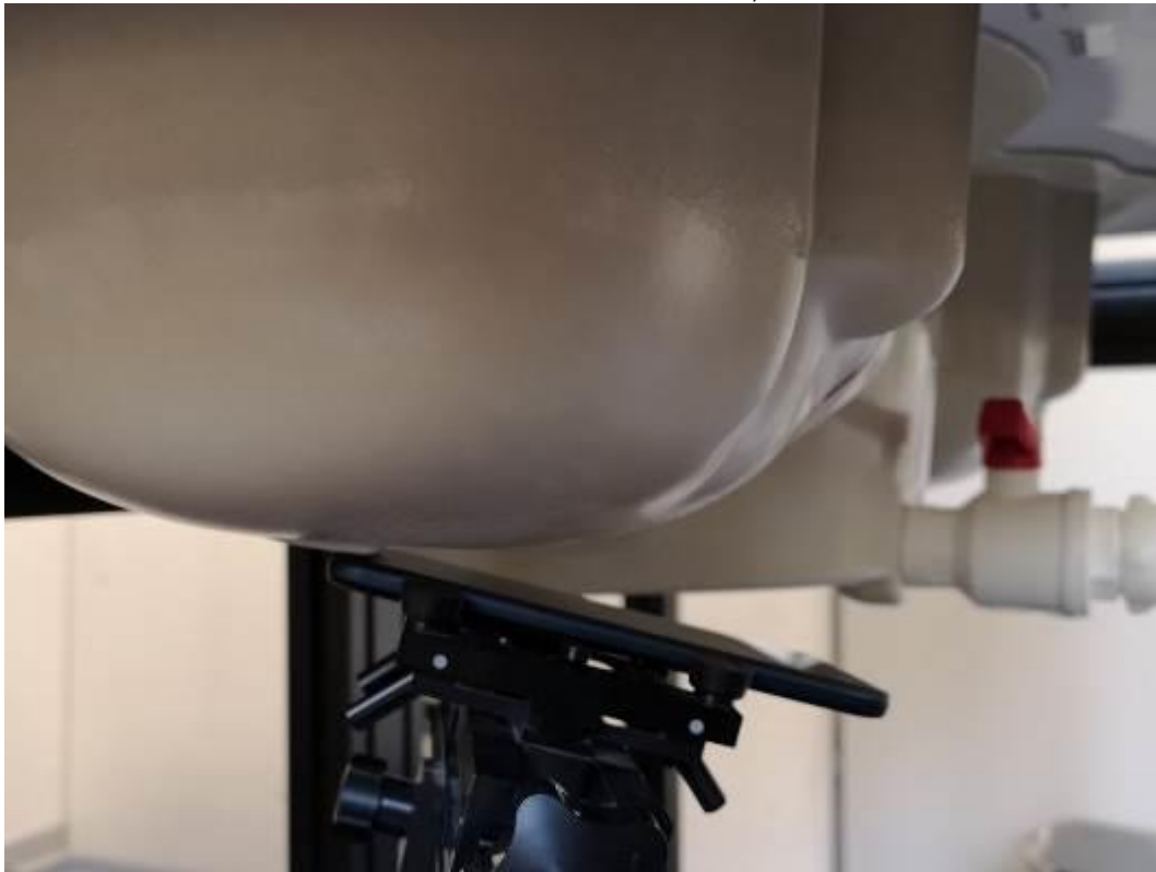
Photo 17: Position d'essai main droite, incliné 15°
