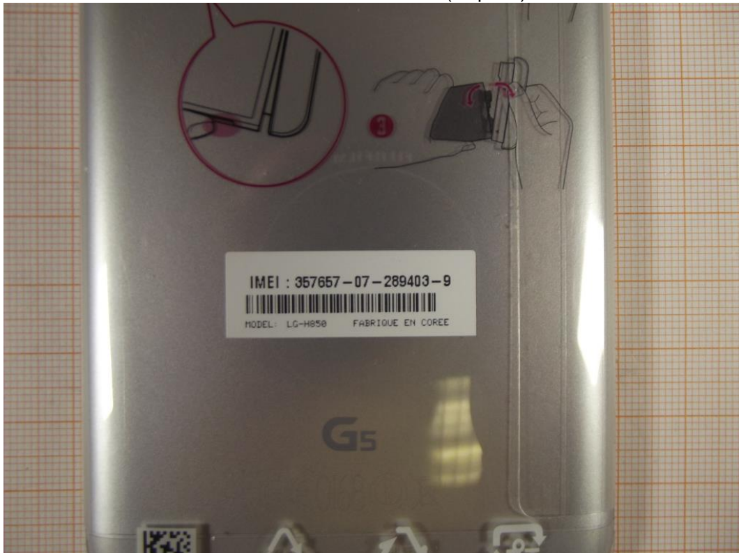
Photo 6: Position d'essai face avant contre le corps (distance 0 mm)
