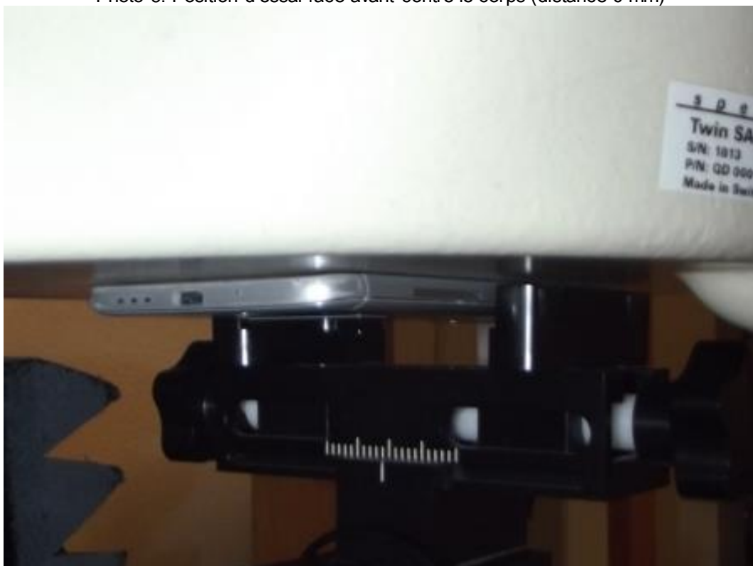
Photo 6: Position d'essai face avant contre le corps (distance 0 mm)
