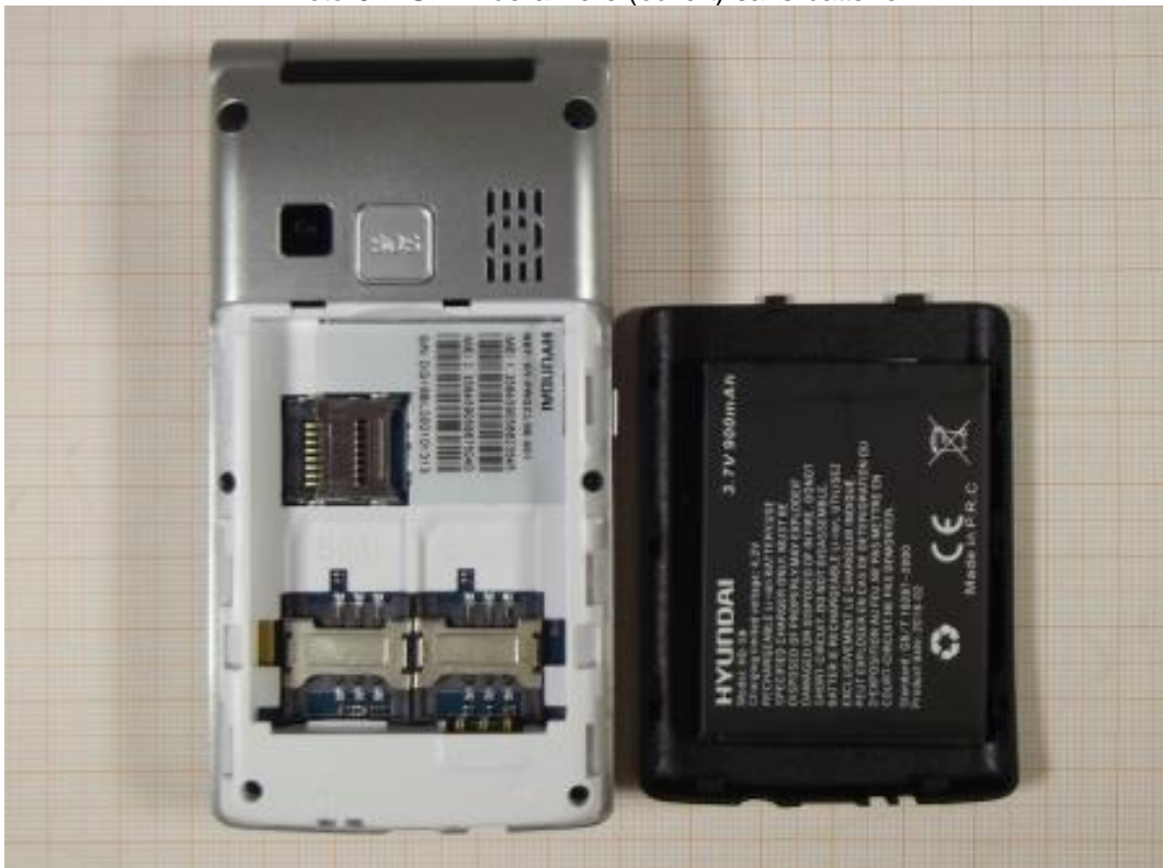
Photo 6: EST – vue arrière (ouvert) sans batterie
