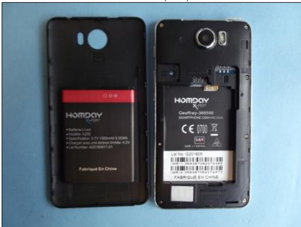
Photo 6: EST – vue arrière (ouvert) sans batterie
