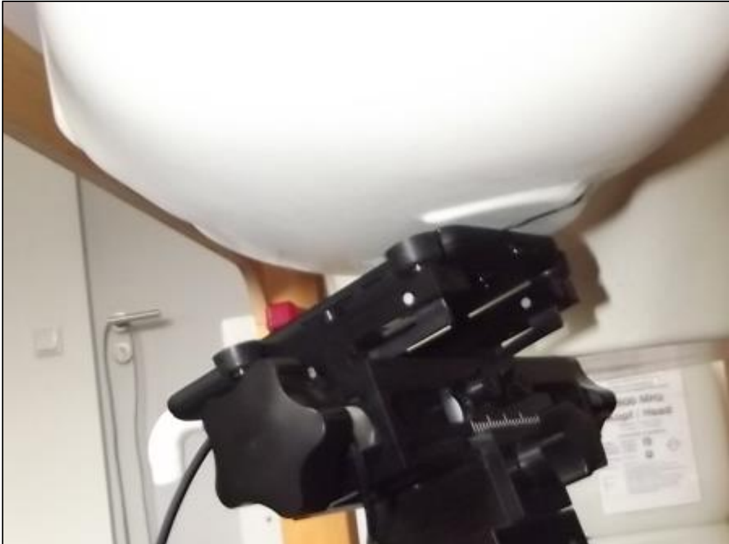
Photo 12: Position d'essai main gauche, incliné 15°
