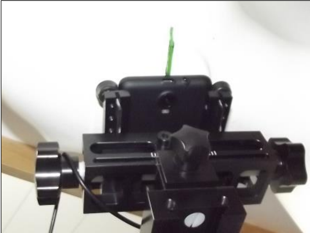
Photo 10: Position d'essai main gauche, contre la joue
