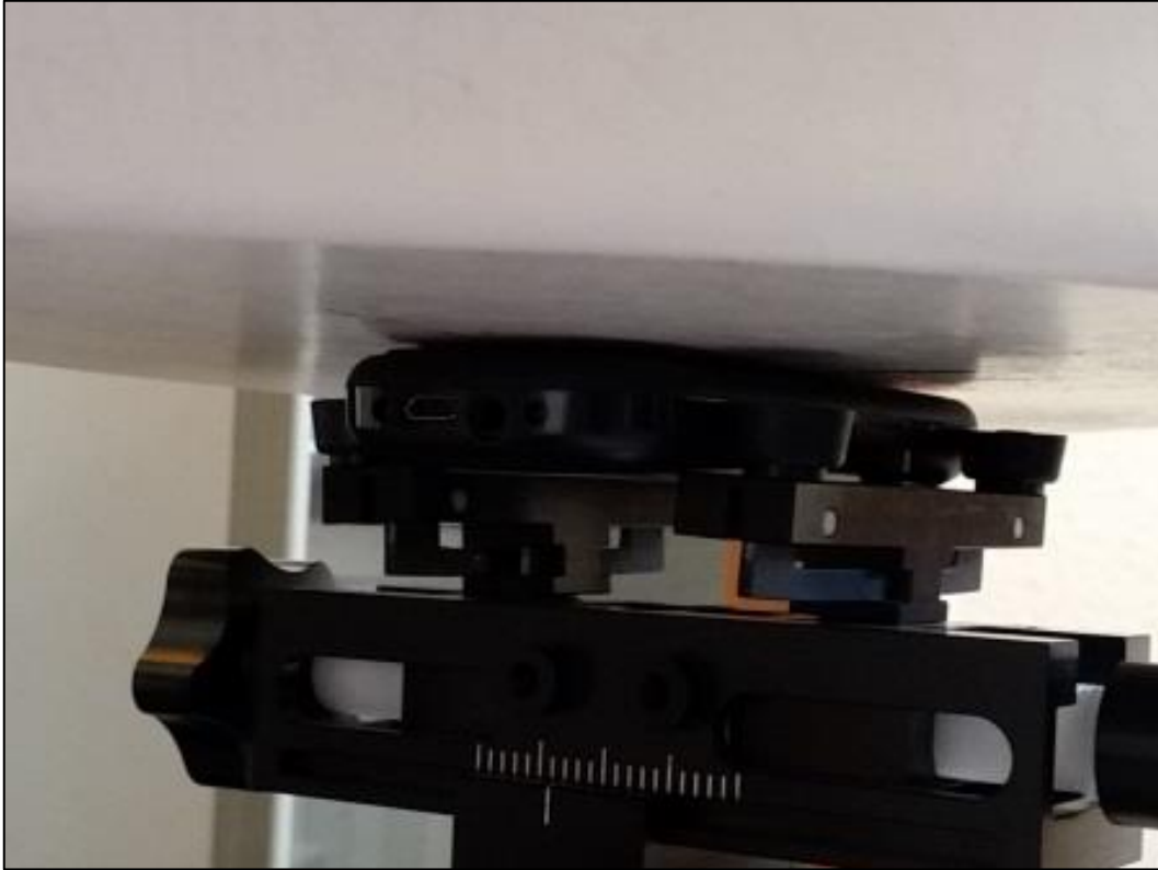
Photo 9: Position d'essai face avant contre le corps (distance 0 mm)
