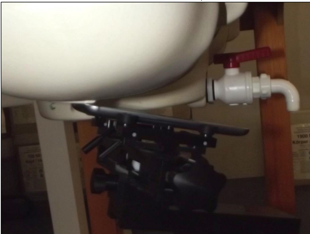
Photo 16: Position d'essai main droite, incliné 15°
