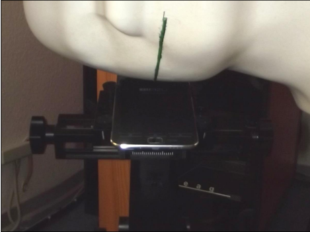
Photo 15: Position d'essai main droite, incliné 15°
