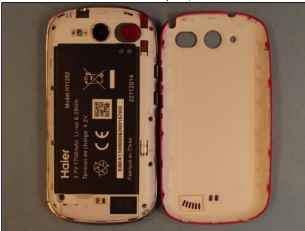
Photo 5: EST – vue arrière (ouvert) avec batterie
