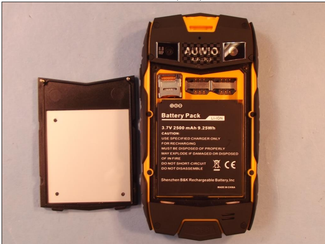
Photo 5: EST – vue arrière (ouvert) avec batterie
