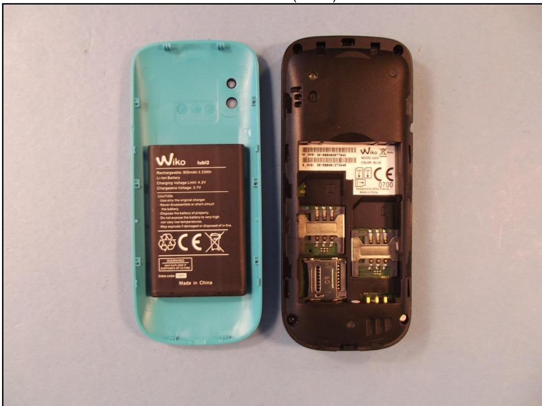
Photo 6: EST – vue arrière (ouvert) sans batterie
