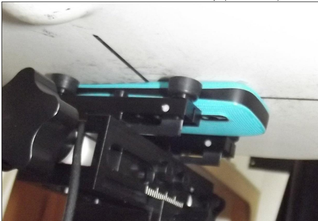
Photo 8: Position d'essai face avant contre le corps (distance 0 mm)
