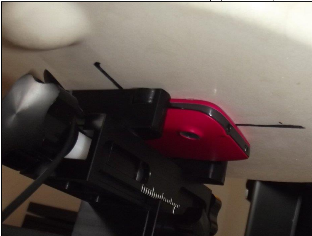
Photo 8: Position d'essai face avant contre le corps (distance 0 mm)
